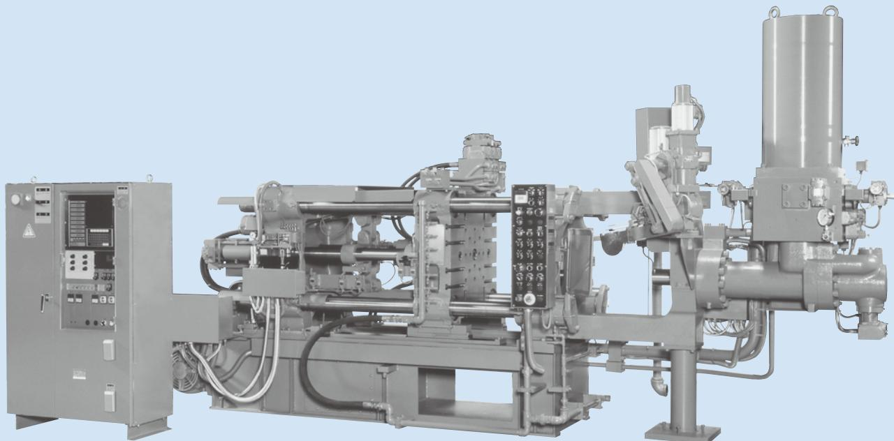
ダイカストマシンの構造が分かるように安全設備を取り外したものを示している。
