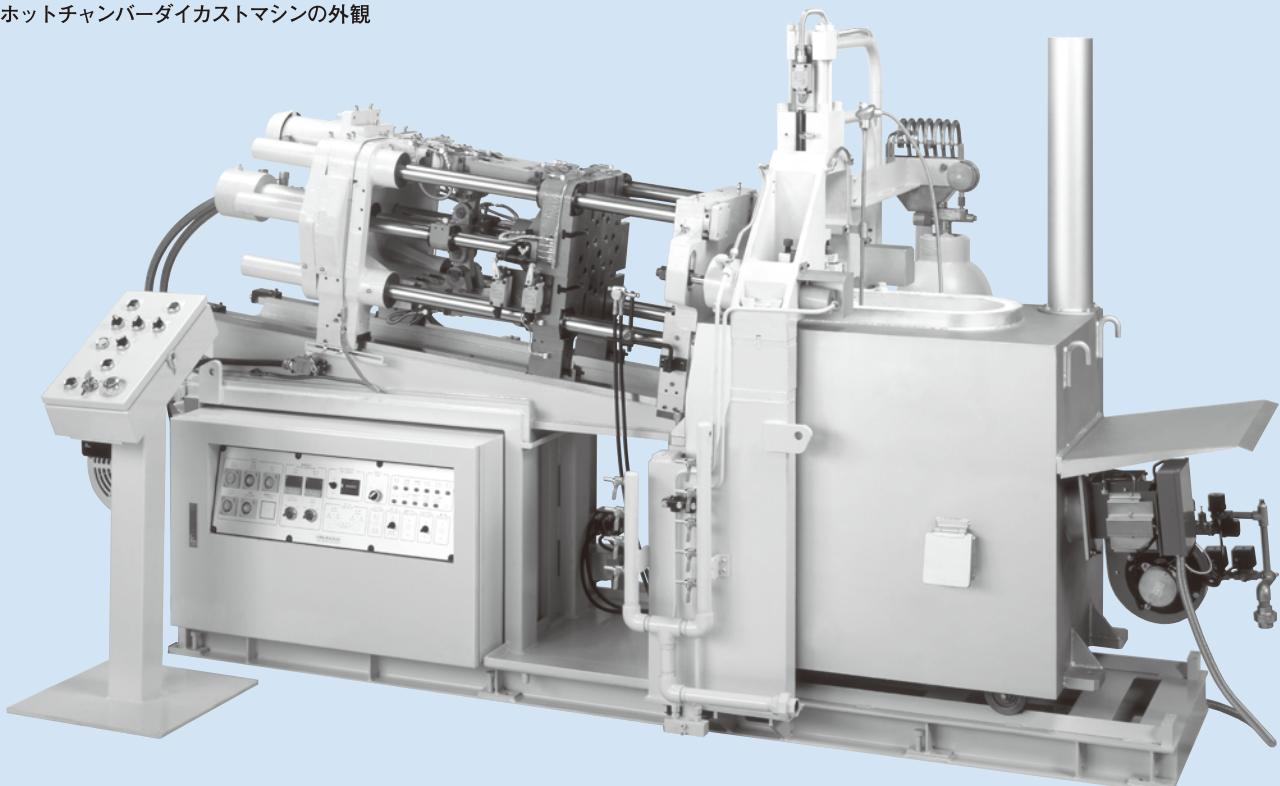
ダイカストマシンの構造が分かるように安全設備を取り外したものを示している。
